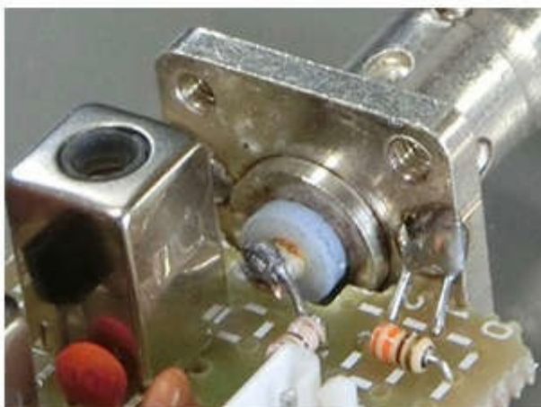
▲写真12 BNCコネクタを直付けしたところです。
