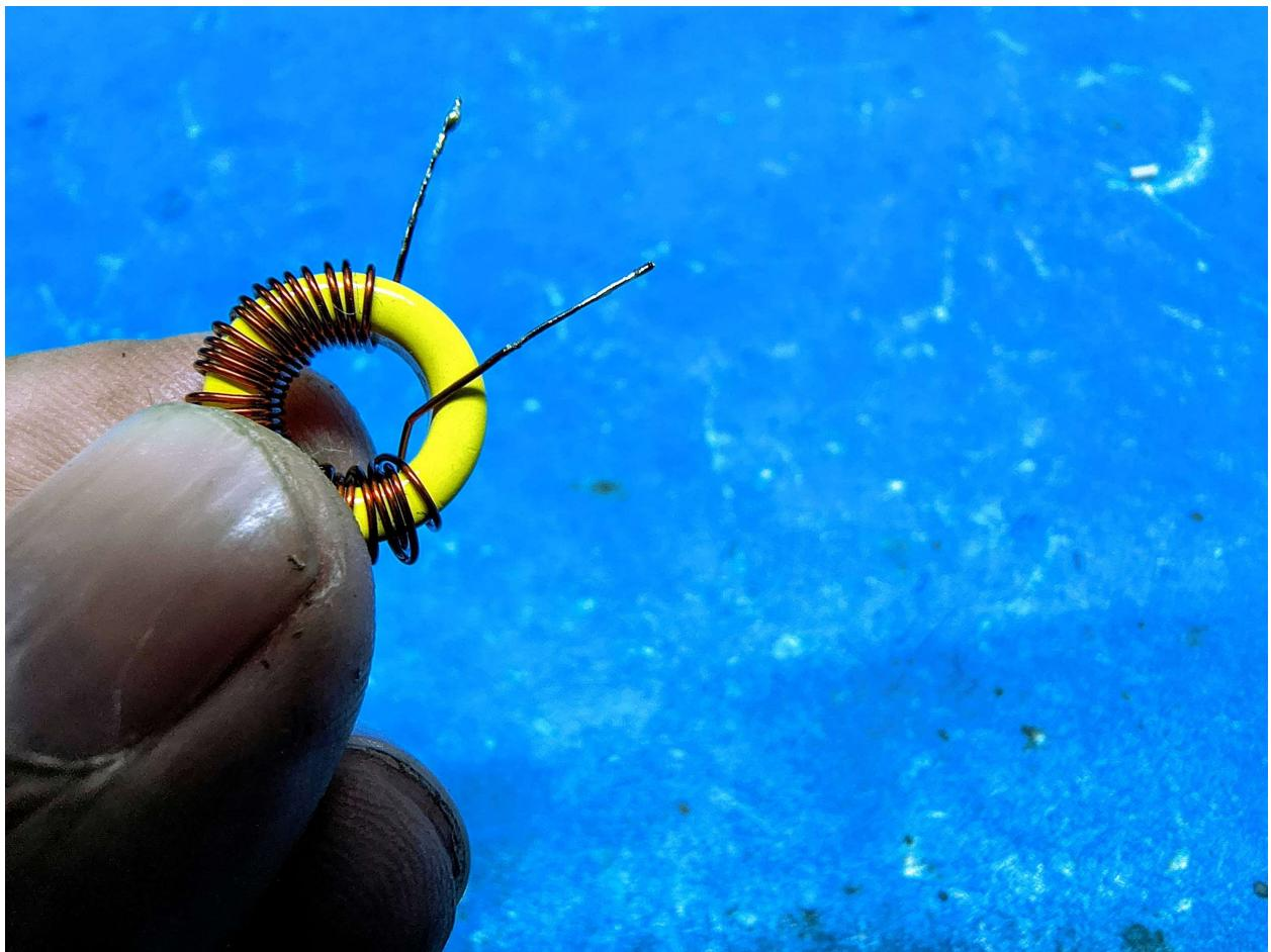
4.6 トロイダルコイルの両端を L1 に並列に半田付けします。
