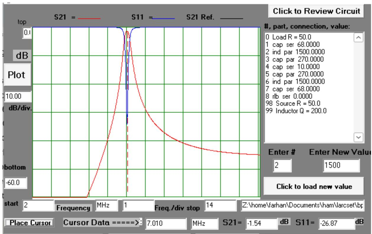
図 2 にはいくつかの興味深い特徴があります。左側(低周波数側)の「スカート」が右側(高周波数側)よりも急峻であることに気付くでしょう。これは異常ではなく、全体的にローパス特性を持つこの種のバンドパスフィルターの「特徴」です。この背後にある数学的背景に関心のある読者は、[https://w7zoi.net/filters/mixed\\_form\\_n=3\\_lc\\_filter.pdf](https://w7zoi.net/filters/mixed_form_n=3_lc_filter.pdf) および <https://w7zoi.net/qststuff.html> のその他の優れた資料をご覧ください。
