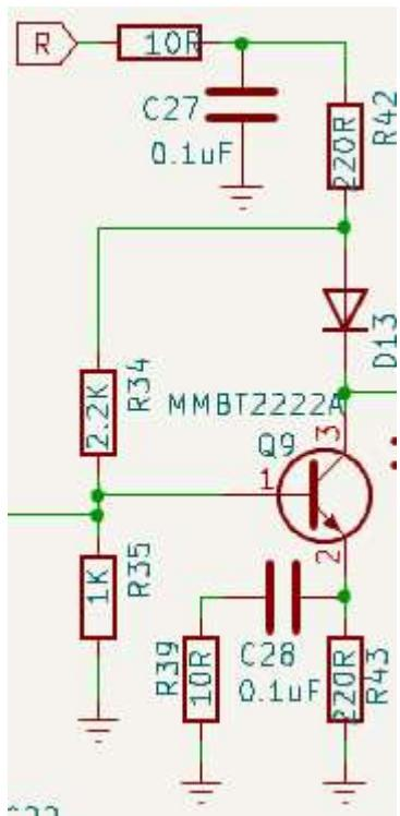
増幅器のコレクタには興味深いダイオードが配置されています。予想される信号レベルにおいて、『R』ラインから増幅器に電源が供給されると、このダイオードは負荷抵抗 R42 と R34 をトランジスタのコレクタに接続する導線のように振る舞います。しかし増幅器がオフになると、ダイオードは逆バイアスされ、220Ω 抵抗と 2.2kΩ 抵抗の両方をコレクタから切り離します。この動作自体は無意味ですが、本回路では増幅器が 2 段直列接続されている点が重要です。このダイオードがオフ時に遮断しなければ、2.2kΩ フィードバック抵抗(図 5 の R34)は逆方向に動作する増幅器の R44 と並列に接続された状態となっていたでしょう。
