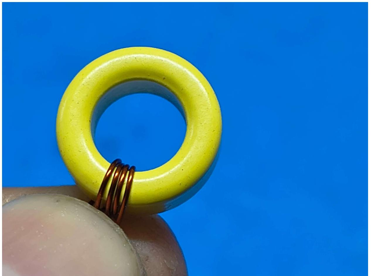
(4 回巻きの VFO トロイダルコイル。巻線が互いに接近しているが重ならず、密に巻かれている点に注意)。
