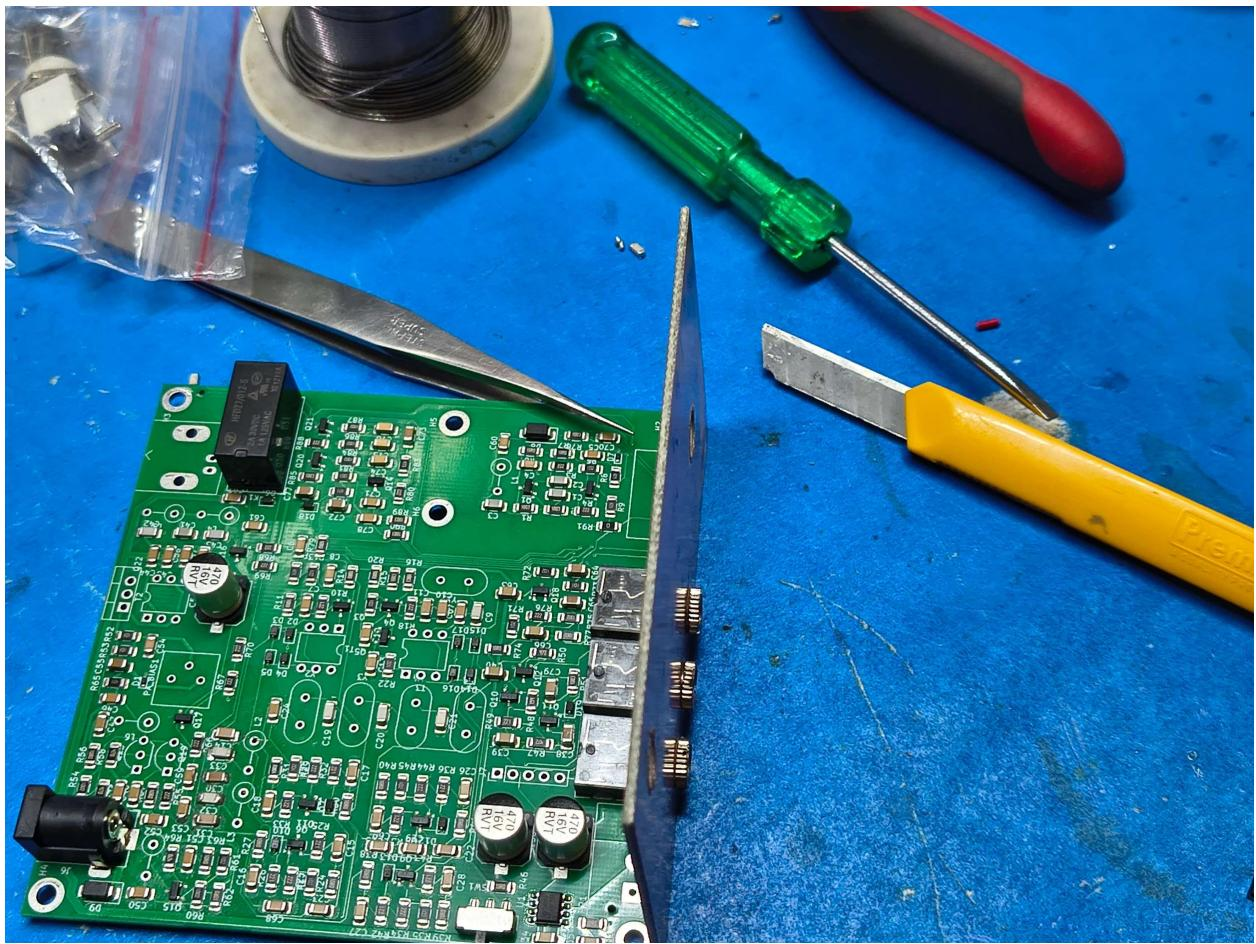
2.3 チューニング用可変抵抗をフロントパネルに挿入し、付属の取付ナットで固定します。この時点ではナットを手で締めて、可変抵抗をしっかりと固定してください。
