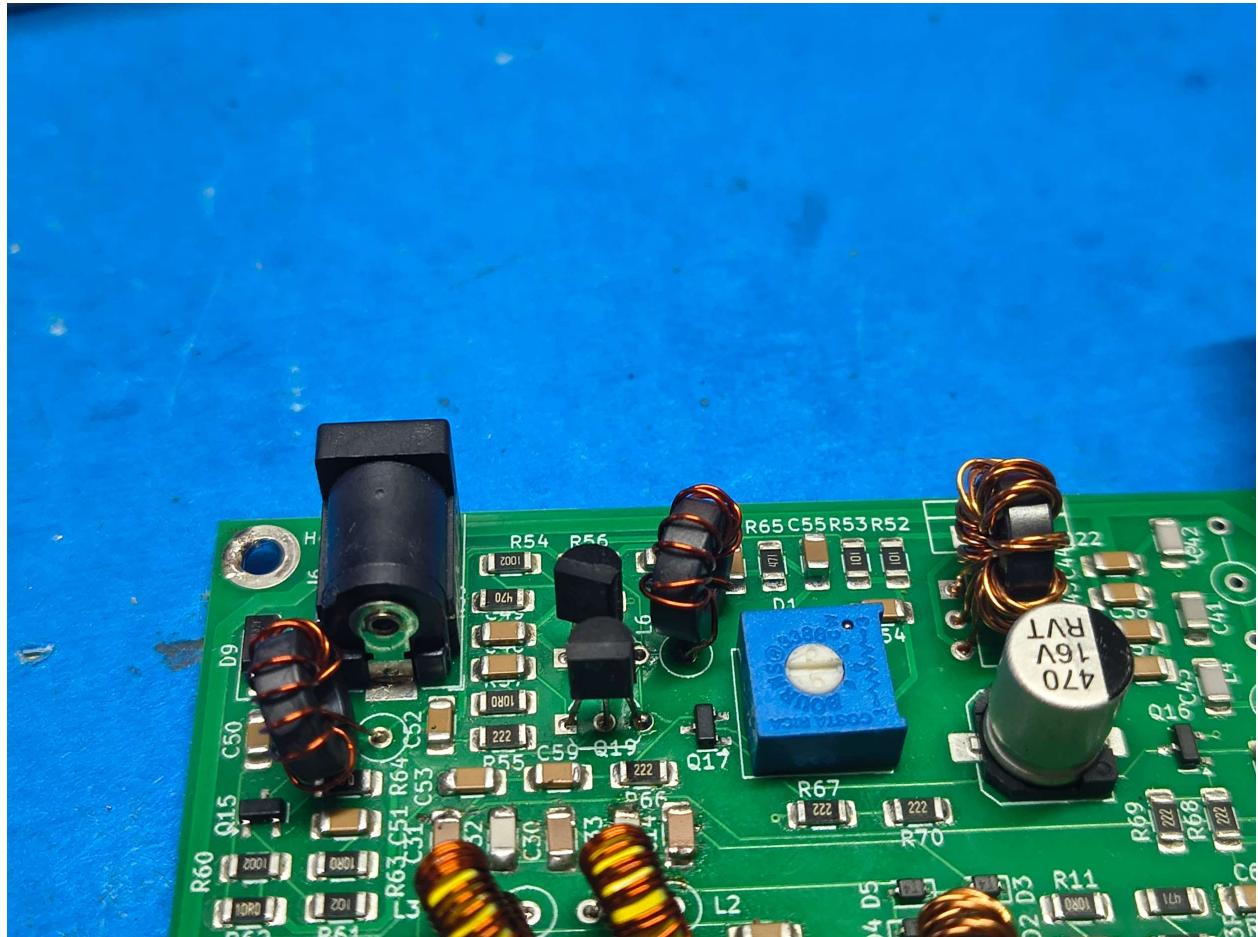
11.4 12インチ(約30cm)のエナメル線を切り取り、2個のT30-6黄色トロイダルのいずれかに17回巻きます。エナメルを削り取り、リード線をはんだ付けします。このインダクタをL5に挿入します。基板端側にあるインダクタのフットプリントです。
