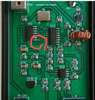
例えば、測定結果が7.05592MHzだった場合、RockyのLocal Oscillatorを7055920と設定します。
