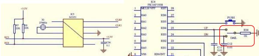
提供されるクロック源により、DDS チップは分解能 10Hz 以下で出力します。DDS システムは、PIC(IC4)チップによる(2線の)I2Cにより制御されます。システムは安定で正確な信号を提供します。
