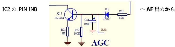
ボリューム可変抵抗の一方から取り出した信号は、ダイオード **D3(1N60)** を介して **Q11** に入力されます。この「DC」電圧は、オーディオ信号 **AGC** システムの一部として、**IC2** の **PIN INB** - セカンドミキサに入力されます。
