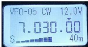
**VFO の周波数ステップ:** **Tune** ノブを短時間押して VFO の周波数ステップを設定/変更します。短時間押すとステップ周波数が変わります(桁の上にある三角形の位置を確認してください)。VFO の周波数ステップは(右から左へ)10Hz、100Hz、1kHz と 100kHz です。
