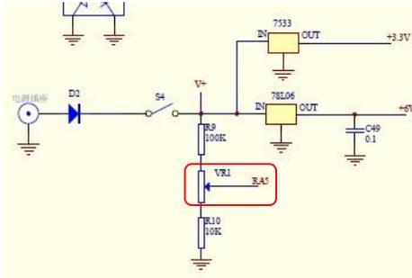
電源バスの一つ目は、安定化されていない DC 入力です。入力された DC 電圧は、PIC コントローラの PIN RA5 により測定します。表示電圧は VR1 により調整可能です。この電源バスは、送信部の PA 部(Q2/Q3)へ供給されています。
