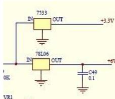
各 DC バスの安定化は、小さな(SMD)ソリッド・ステート・レギュレーター・デバイスにより提供されます。これらの三端子デバイスは丈夫で、長時間の送信などでバッテリーが限界に達している状況でも、電源の変化に応じて優れた電圧安定性を提供します。
