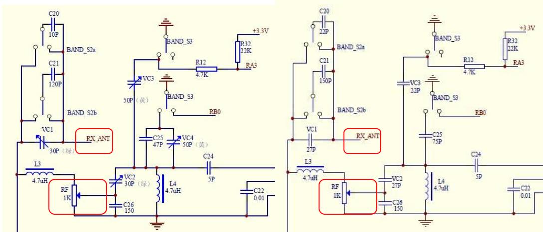
バンドスイッチ(Band\_S2 と-S3)は入力フィルタの部品を切り替えるだけでなく、識別のための線を HI/LOW に切り替えることで、RA3 と RB0 を通して期待するバンド情報(選択)を MCU に提供します。
