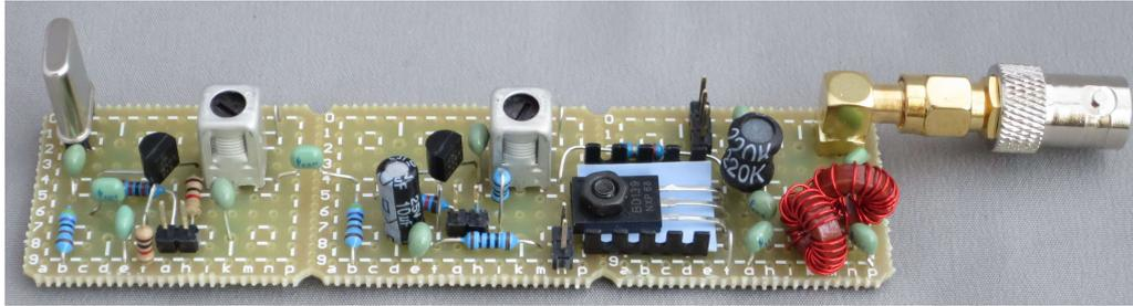
QP-7C キットはミズホ通信のQP-7のコンセプトをそのままに、より高性能、低スプリアスとした3ステージCW送信機キットです。送信機を自分の手で作り電波を出すというアマチュア無線本来の楽しみを各局にお届けします。QP-7Cでは理解しやすい3ステージ分離などQP-7の良さを残しつつ、発振回路はピアースCBからコルピッツに、新スプリアスに対応する楕円フィルタなどの変更が行われています。
