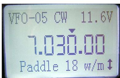
R/T/SPD ボタンを 2 秒以上押し続けると、キーヤ速度設定モードに変わります。LCD の下部右側に上向き↑または下向き↓の矢印が表示されます。この時にボタンを離し(押すのを止め)同調ツマミを回すと、速度を変更可能です。R/T/SPD ボタンを押すと、新しい速度を保存し、キーヤ速度設定モードを抜けます(ハンドキーにはこの機能は適用されません)。
