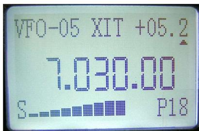
RIT または XIT を使用したり解除します。LCD には、RIT または XIT とオフセット周波数が表示されます。RIT と XIT を切り替えるためには、オフセット周波数変更モード時に同調ツマミを回します。同調ツマミを回すと、RX または TX の周波数のオフセットを設定可能です。RIT ステップは 10Hz、XIT ステップは 100Hz です。
