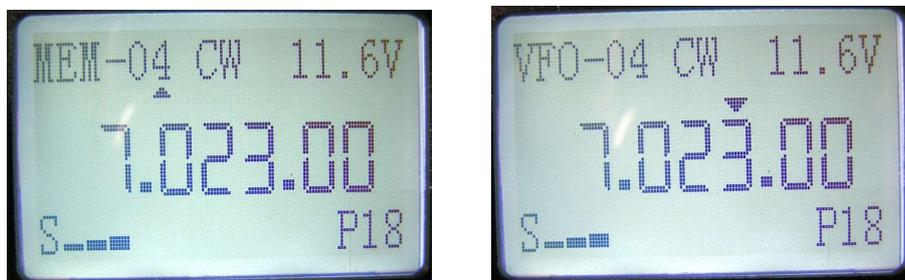
メモリモードと VFO モード間を切り替えます。LCD の上部左側にそれぞれ MEM-\*\*または VFO-\*\*と表示されます(-\*\* は 01~16 までの数字です)。M/V/SAV ボタンを 2 秒以上押し続けると、現在の周波数とモードが現在のメモリに保存されます。LCD には、Sav-\*\*と表示されます。電源起動時の周波数とモードの初期値は、最後に保存された周波数とモードになります。
