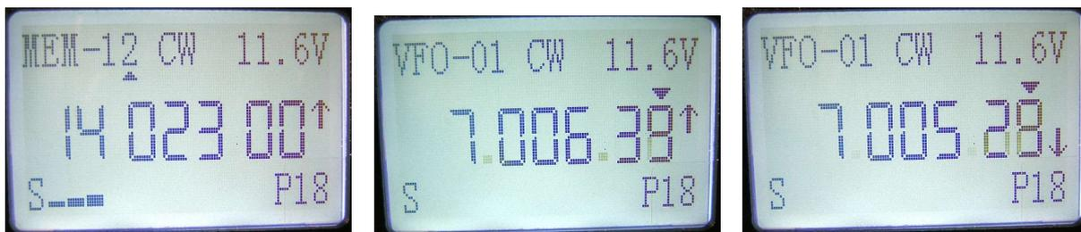
MEM モードで、同調ツマミを 2 秒以上押し続けると、メモリオートスキャンモードに変わり、16 個のメモリチャンネルをスキャンします。スキャン中に M/V/SAV ボタンまたは R/T/SPD を押すと、スキャン方向が変わります。VFO モードで、同調ツマミを 2 秒以上押し続けると、周波数オートスキャンモードに変わります。スキャン中に、M/V/SAV ボタンまたは R/T/SPD を押すと、スキャン方向が変わります。スキャンステップは、同調ツマミを押して、10Hz または 100Hz から選択します。LCD にはスキャン方向が表示されます。再度同調ツマミを 2 秒以上押し続けると、オートスキャンモードを終了します。
