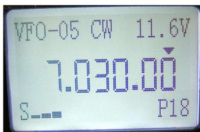
同調ツマミを押し、周波数ステップを 10 Hz、100 Hz、1 kHz または 100 kHz から選択します。現在の周波数ステップは LCD の中の小さな矢印で表示されています。この機能は VFO モードにだけ有効で、MEM モードでは使用できません。
