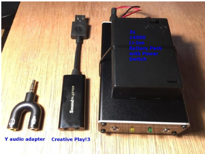
ヘッドセット用のコネクタ 1 個しかないコンピュータの場合、Y 型オーディオアダプタが役立ちます。通常、マイクロホンとヘッドホンのコネクタが一緒になった 4 ピンのコネクタで、スマートホンのコネクタと同じものです。Y アダプタは、マイクロホンとヘッドホンのコネクタを分けて、別のコネクタにし、同封のオーディオケーブルを使用してそれを D4D に接続します。
