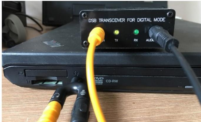
ヘッドセット用のコネクタが一つだけある新しいコンピュータの場合、Yアダプタを使用して接続します。Yアダプタはオプションとして入手可能です。
