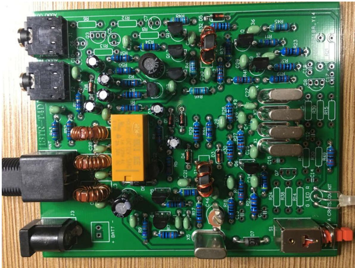
このステップの終了後、送信部をテストします。再びスマートホンを使用して、2000Hzのオーディオ信号を発生します。アンテナコネクタに接続する50Ωのダミーロードも必要です。電源を電源コネクタJ3に接続し、スイッチS1を押します。J2にオーディオ信号を入力し、手近の受信機を7.076MHzにあわせて、何か信号が聞こえるかどうか確認します。S1をOFFにしてS1に流れる電流値を測定し、TX時に大体300-350mAであることを確認します。
